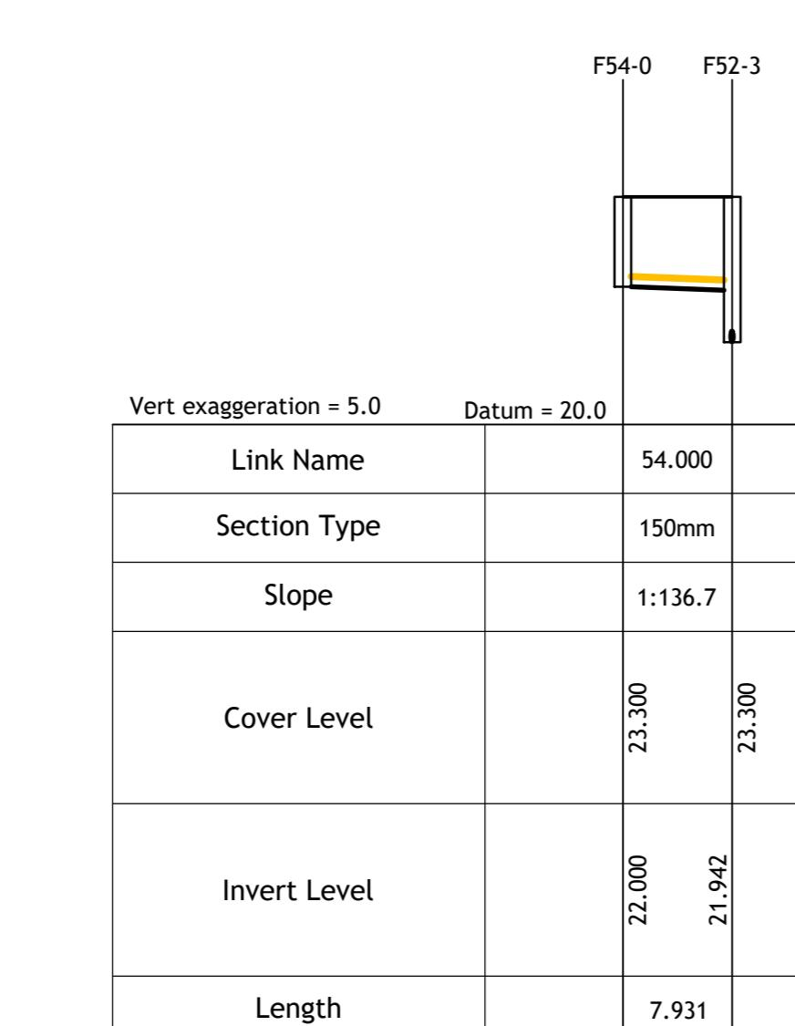
**PIPERUN 54 - FOUL BASEMENT LEVEL -2 - LONGITUDINAL SECTION**
