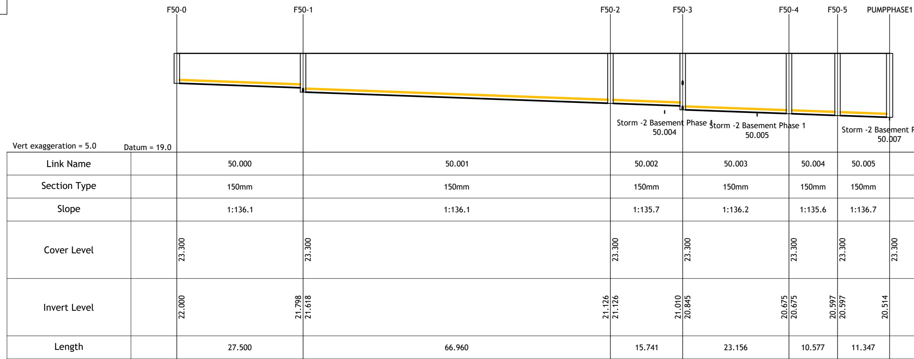
**PIPERUN 50 - FOUL BASEMENT LEVEL -2 - LONGITUDINAL SECTION**
