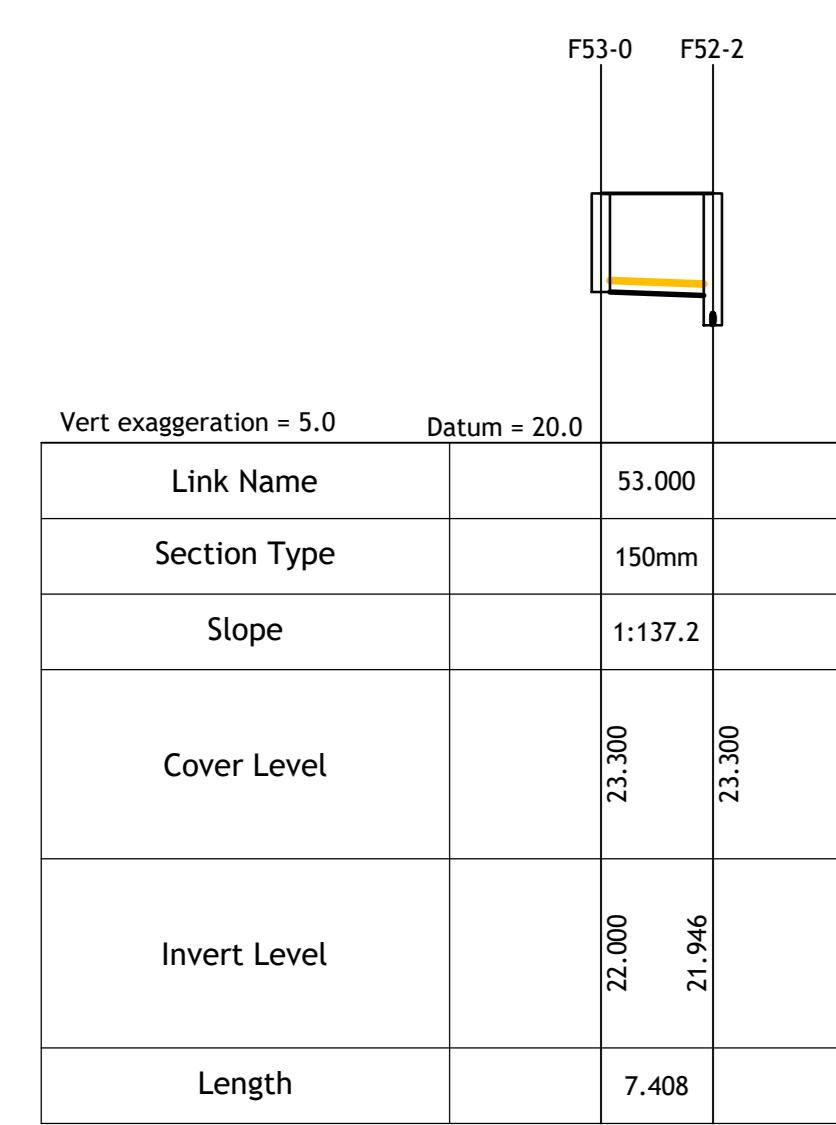
**PIPERUN 53 - FOUL BASEMENT LEVEL -2 - LONGITUDINAL SECTION**
