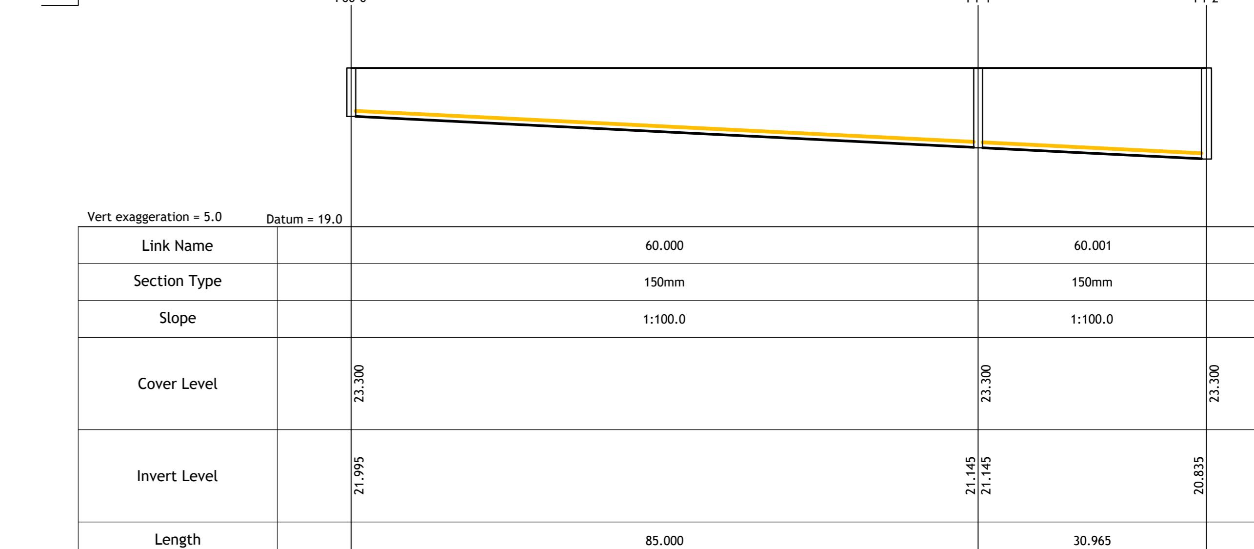
**PIPERUN 60 - FOUL BASEMENT LEVEL -2 - LONGITUDINAL SECTION**
