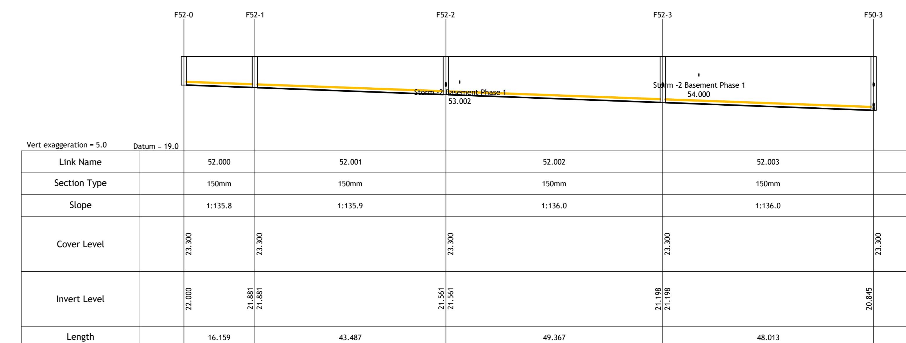
PIPERUN 52 - FOUL BASEMENT LEVEL -2 - LONGITUDINAL SECTION
